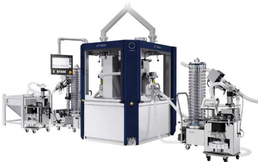
Vollständig integrierte Tablettiersysteme bestehen aus der Tablettenpresse und den dazugehörigen Peripheriegeräten. Unsere Fachleute stellen diese Geräte für den gesamten Prozess optimal zusammen, von der Materialbeschickung bis hin zum Sammelsystem. Dank seiner langjährigen Erfahrung kennt KORSCH die besten Verfahren für optimale Lösungen.
