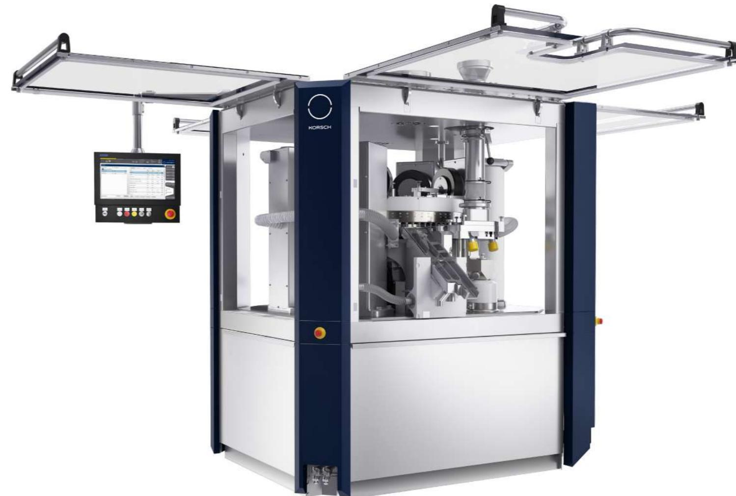
Die XT 600 ist flexibel einsetzbar und produziert maximal 1.380.000 Einschichttabletten oder 414.000 Zweischichttabletten pro Stunde. Ein Zweischicht-Umrüstsatz, der die Komponenten für die Gewichtsregelung der einzelnen Schichten, den Musterzug der ersten Schicht und die vollständige Trennung der Produktschichten enthält, kann jederzeit für die Maschine nachgerüstet werden.
